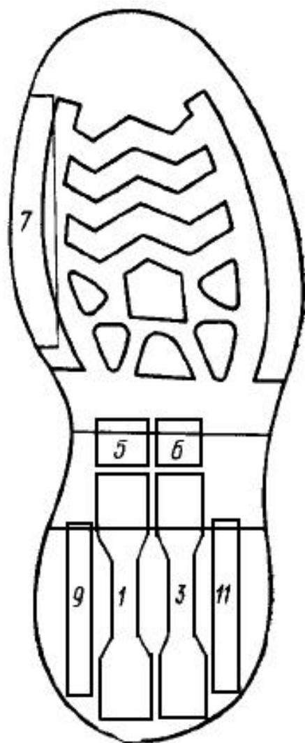
1, 3 - образцы для определения предела прочности при разрыве, относительного и относительного остаточного удлинения; 9, 11 - образцы для определения сопротивления многократному изгибу; 7 - образец для определения сопротивления вырыванию шпильки; 5, 6 - образцы для определения плотности и истираемости
